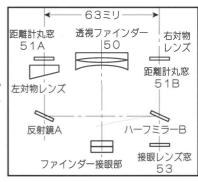
して接眼レンズに入ります。従って左右対物レンズからの2つの像が二重像で見られます。この反射鏡 Aの回転によって左右からの2つの像を完全に合致させたとき、その被写体距離を目盛りで示したもの が距離計です。WISTA45RFは、この二重像合致機構を利用しておりますが、距離を測定することが目 的ではなくピント合わせを行うための装置として利用しています。
