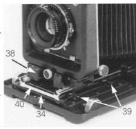
により最後までしっかり繰り入れ、繰り出しトラックロックレバー(29)を固定します。このとき距離計二重像は無限遠で合致していなければなりません。つぎに上部トラック(40)上の三色の無限遠ストッパー(45)をゆるめ移動できる状態にします。次いでレンズ支柱引き出しつまみ(38)を操作し、前後して無限遠被写体をピントグラス上で正しく合わせます。ピントの合った位置でレンズ支柱(31)を止め、三色の無限遠ストッパー(45)を移動してレンズ支柱に突き当てねじ回しで三色の無限遠ストッパー(45)を固定します。以上で連動距離計の二重像合致時はピントガラス上で完全にピントが合っていなければなりません。
